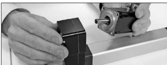
3. 使用一个六边形扳手固电机轴周围的联轴器。
