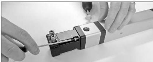
4. 使用一个六边形扳手固电机轴周围的联轴器。
