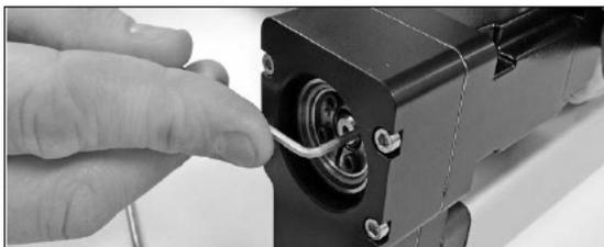
4. 用四个螺钉将电机固定在法兰上，按表 T6.3.1 拧紧螺钉。
