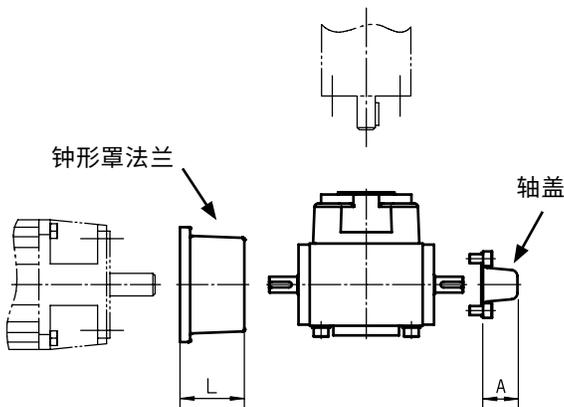
为将齿轮安装到电机上，必须在齿轮和电机之间使用钟形罩法兰。钟形罩法兰（包含一个配套的联轴器）需单独订购。您可以订购轴盖来遮盖未处于使用状态下的第二主轴。
