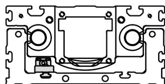
每个2HB和2RB可将传感器安装在导轨内以避免机械损坏。这些型号在每个端板两侧提供传感器套装电缆的进线孔。使用限位开关传感器会减少有效行程。Sdetract所列的距离是传感器安装在标准位置时的行程减少数值。订购代码2HB、2RB、2HE和2RE可选配限位开关和/或原位传感器作为组件的一部分。详情请参考订购代码或访问网站[www.linearmotioneering.com](http://www.linearmotioneering.com)。上面所列单个零件的零件号。
