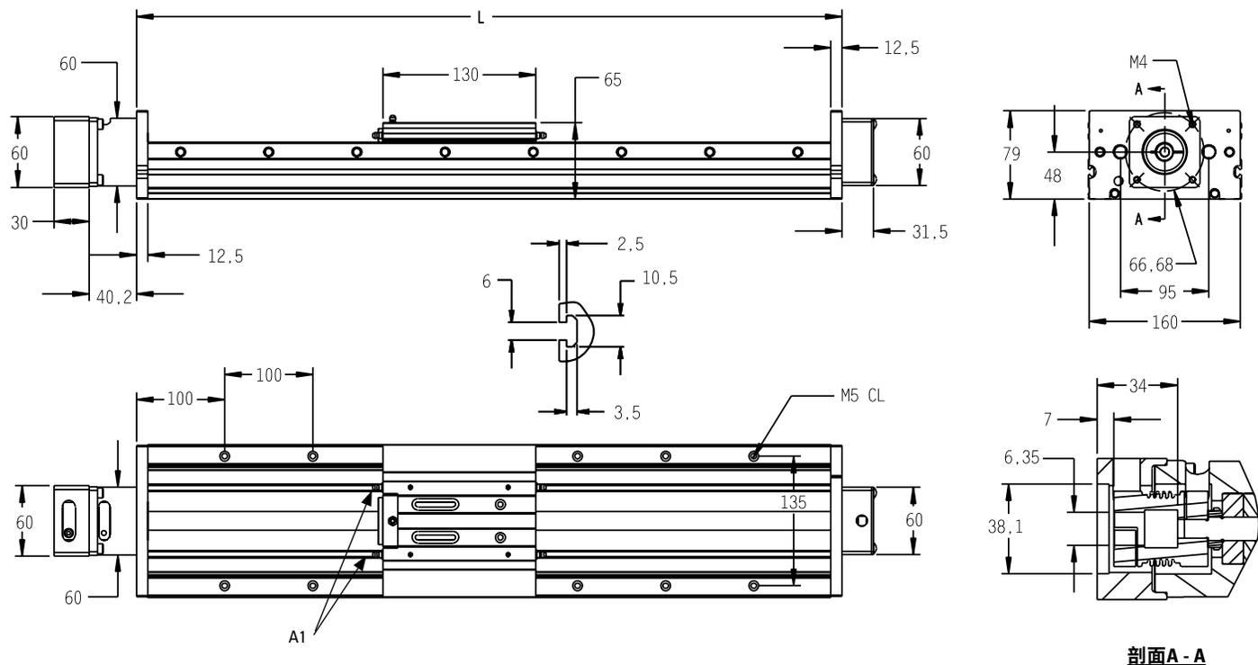
A1: 润滑喷嘴 (带喷嘴的型号行程缩短10 mm)。
