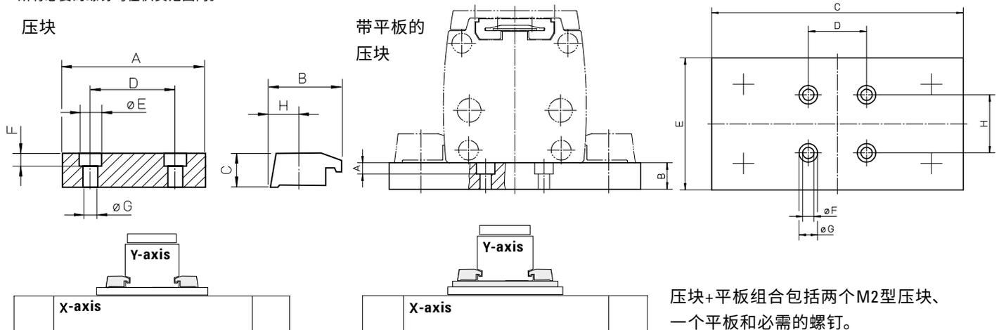
压块+平板组合包括两个M2型压块、一个平板和必需的螺钉。
