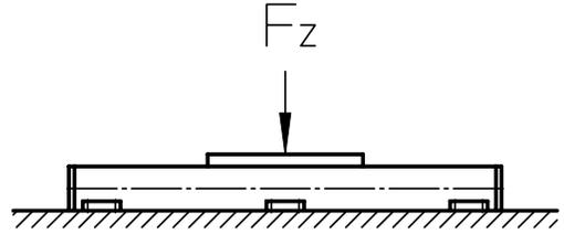
必须使用机加工表面沿整个长度在底部连续支撑单元。
