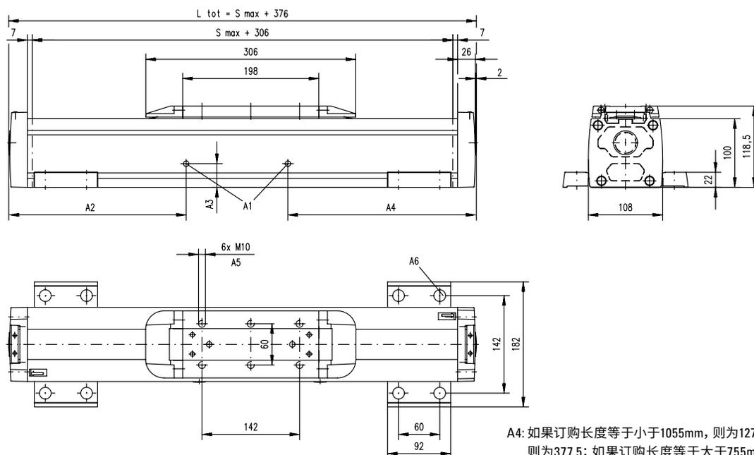
A1: 滑轨紧度孔 $\phi 6$  (MG10N)、 $\phi 10$  (MF10N)
