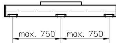
为操纵最大负载，必须至少每隔750mm安装一个安装压块。若所需操纵的负载更小，则相应安装的压块也可减少，请参阅其它技术资料了解更多信息。
