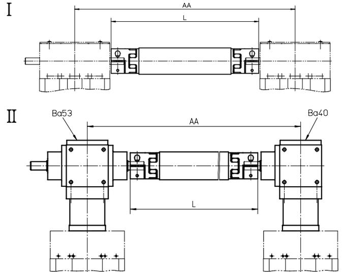
VWZ中间轴的安装方式有两种。直接安装到皮带驱动单元 (I) 或使用类型为VL50、VL100或VL200的KRG斜齿轮 (II) 安装到丝杠驱动单元。但是，安装有RediMount法兰的皮带驱动单元不可与VWZ中间轴组合使用，只有丝杠驱动单元可以。在这种情况下，订购单元时必须确保RediMount ID代码与涉及的斜齿轮相匹配。中间轴包括软管和联轴器。
