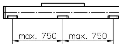
为操纵最大负载，必须至少每隔750mm安装一个安装压块。若所需操纵的负载较小，则相应安装的压块也可减少，请参阅其它技术资料了解更多信息。当总长超过6300mm时直线运动系统由两部分型材拼接而成，须对接合点的两侧均进行适当的支撑。
