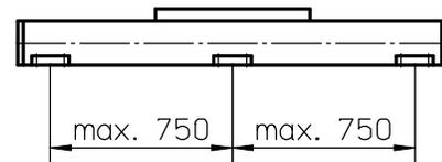
为操纵最大负载，必须至少每隔750mm安装一个安装压块。若所需操纵的负载更小，则相应安装的压块也可减少，请参阅其它技术资料了解更多信息。当总长超过4,900 mm时直线运动系统由两部分型材拼接而成，须对接合点的两侧均进行适当的支撑。
