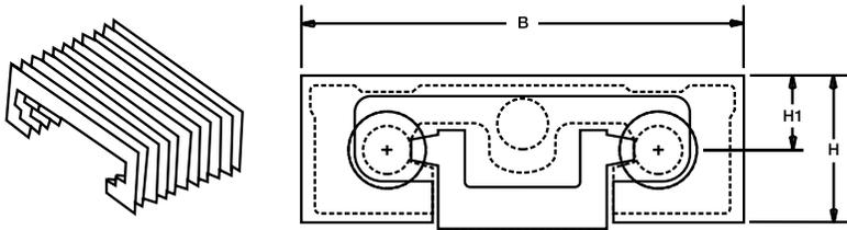
波纹管起到防尘作用。注意，选用波纹管会将有效行程减少28%。波纹管既可在随单元一起订购并由工厂预装（见订货号），也可以单独订购并由用户自行安装。在后者情况下，请订购两根波纹管，每根长度=单元行程×0.86。
