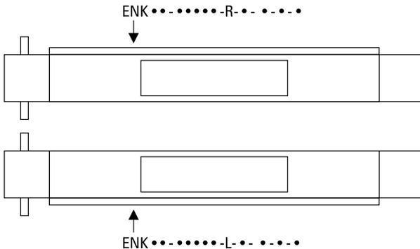
ENF和ENK感应传感器导轨选件包已在出厂前安装。ENF选件包括两根500mm长ENT14x16传感器导轨,其安装在单元每个末端左侧或右侧导轨上。若因单元太短而无法安装两根500mm传感器导轨,则将一根导轨沿着整个单元导轨安装。ENK选件也包括ENT14x16传感器导轨,但ENK选件贯穿单元整个导轨的传感器导轨。无论ENF还是ENK,发货时都包含特定数量和种类的EN2传感器。传感器由客户视其实际需要安装在传感器导轨上的相应位置。
