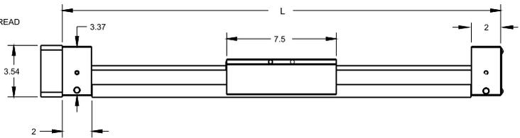
上图所示为标准NEMA23电机的尺寸。还提供其他安装尺寸配置。详情请访问[www.linear-motioneering.com](http://www.linear-motioneering.com)。
