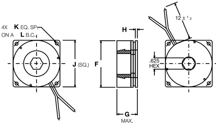
安装到2HB、2RB和2DB型的末端支撑上。该制动器可在断电时施闸，防止滚珠丝杠由于重力作用而反向旋转。它们经过预抛光，扭矩大，附带标准NEMA 23、34或42安装形式，易于现场改装。外形紧凑有助于减少对整体系统包络的改动。2HB、2RB和2DB订购代码可以作为组件的一部分来配置制动器。详情请参考订购代码或访问网站[www.linearmotioneering.com](http://www.linearmotioneering.com)。此处所列的制动器零件号为单个零件。
