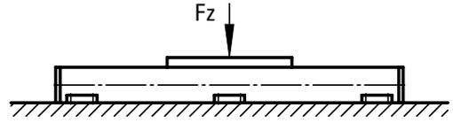
必须使用机加工表面沿整个长度在底部连续支撑单元。
