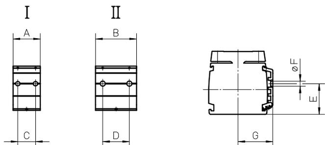
适配板沿着导轨安装在沟槽中，可用于将诸如传感器、开关、线缆管道等组件连接到单元上。
