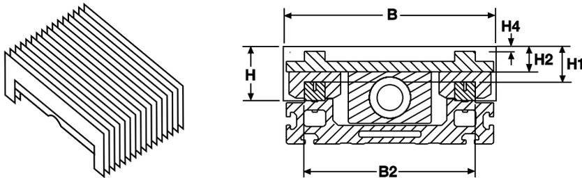
波纹管起到防尘作用。注意，选用波纹管会将有效行程减少28%。波纹管既可在随单元一起订购并由工厂预装（见订货号），也可以单独订购并由用户自行安装。在后者情况下，请订购两根波纹管，每根长度=单元行程×0.86。
