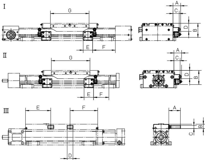
ES限位开关组件是一个在出厂前安装的选件。限位开关处于距单元机械末端10mm处。每个限位开关都带有正向开启动作的常开和常闭触点。其防护级别为IP67。I型和II型开关可由用户沿着导轨重新定位。注意！ES限位开关选件和所有传感器导轨选件（ENT14x16，ENF14x16或ENK）不可安装于单元的同侧。
