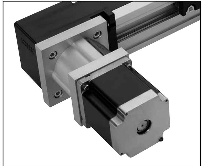
安装时，将电机插入接口法兰，连接并紧固电机螺栓，然后将联轴器紧固至电机轴。最后，用栓塞封住联轴器的访问窗口。
