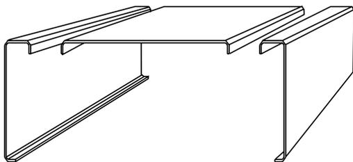
防护罩为金属材质，可防止灰尘进入单元驱动机构内，但无法保护导轨。它不会减少单元行程，但会将单元宽度增加4毫米。用户可在订货号中注明来订购防护罩并由工厂预装。
