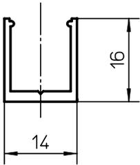
ENT14x16感应传感器导轨应安装在单元一侧或沿着任何类型的梁或导轨安装。EN2型感应传感器可安装在导轨内。导轨也可作为传感器电缆管道。导轨已采用盖板(与导轨一同交付)密封。交付的导轨最大长度为3000mm。安装导轨时,需要在单元导轨上钻孔。订购时应指明订货号和导轨长度。
