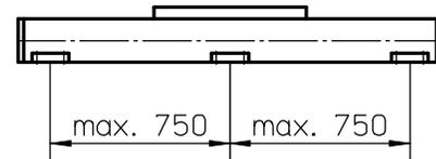
为操纵最大负载，必须至少每隔750mm安装一个安装压块。若所需操纵的负载更小，则相应安装的压块也可减少，请参阅其它技术资料了解更多信息。当总长超过6300mm时直线运动系统由两部分型材拼接而成，须对接合点的两侧均进行适当的支撑。
