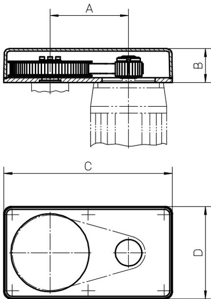
BGM皮带齿轮仅可用于未安装RediMount法兰的单元。皮带齿轮拆解交付, 须由客户自行组装到单元和电机上。
