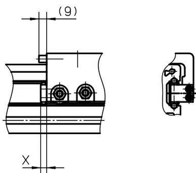
毡垫刮刷器位于滑架上，用于清除导轨上面的污垢和灰尘。它们的存在可能造成驱动扭矩稍稍增加，但单元的行程并未因此减少。毡垫刮刷器作为标配在出厂时已安装在所有WH和WHZ单元上，但也可作为备件单独订购。
