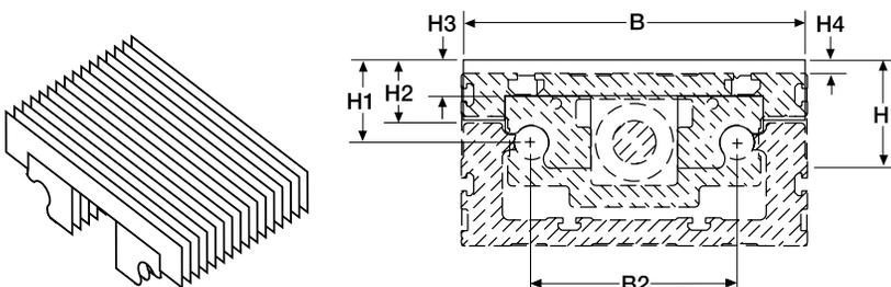
波纹管起到防尘作用。注意，选用波纹管会将有效行程减少28%。波纹管既可在随单元一起订购并由工厂预装（见订货号），也可以单独订购并由用户自行安装。在后者情况下，请订购两根波纹管，每根长度=单元行程×0.86。
