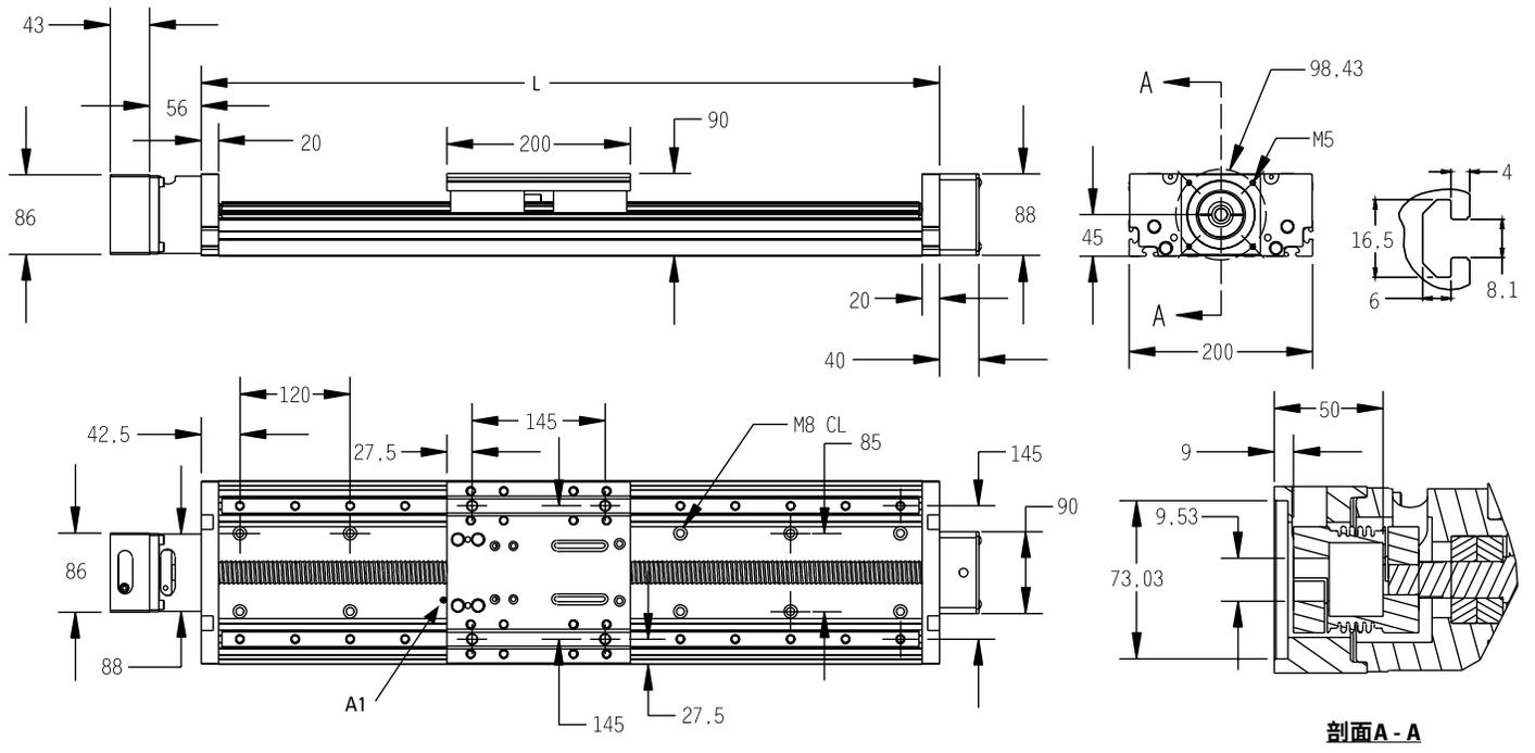
A1: 润滑喷嘴 (带喷嘴的型号行程缩短10 mm)。
