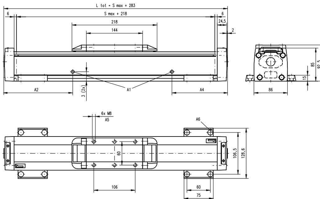
A1: 滑轨紧度孔 $\phi 6$  (MG07N)、润滑孔 $\phi 10$  (MF07N)
